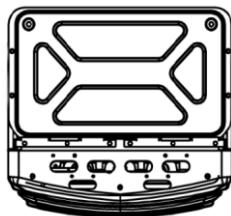
Pomocou 4 skrutiek veľkosti M5 x 10 upevnite dokopy spodný panel s bočnými panelmi
