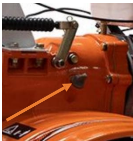
Obr. 5 - Verificarea nivelului de ulei al transmisiei
