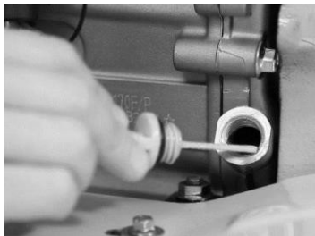
Obr. 5 - Verificarea nivelului de ulei la motor
