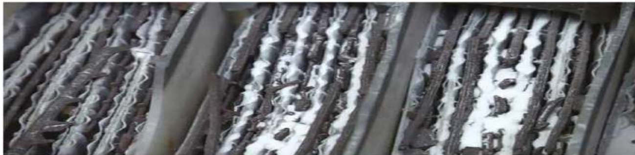
Obrázok č.1, opotrebovanie batérií javom zvaným sulfatácia , ak zabudnete batériu nabíjať na 100%, kryštály sulfatácie sa postupne množia a znižujú kapacitu batérie až ju úplne degradujú. Preto je nutné dodržať inštrukciu č.1 vyššie, „Vozík je potrebné nabiť bezprostredne po každom i najmenšom vybití a to do plna“
